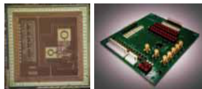
図3 三洋半導体と開発した完全デジタルPLL-TVチューナーLSIを実装した評価基板。0.18 \mu m CMOSプロセスで設計試作したLSIをワイヤボンディングで評価基板と直接接続し、多数の制御信号ピンやスイッチを基板上に実装することで、より高度な測定評価を可能とした。TVチューナー用完全デジタルPLL LSIの開発は世界初。
